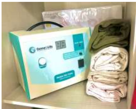
Fig. 1 - Desinfecção de ambientes, com uso de ozônio em forma de gás.
